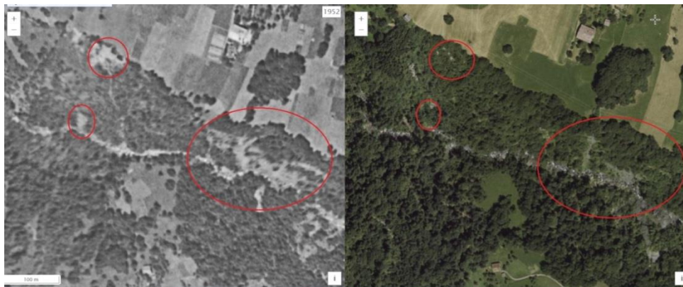
Figure 27 Exemples de glissements stabilisés (revégétalisation) en amont du PK 3.0 de la Sallanche
