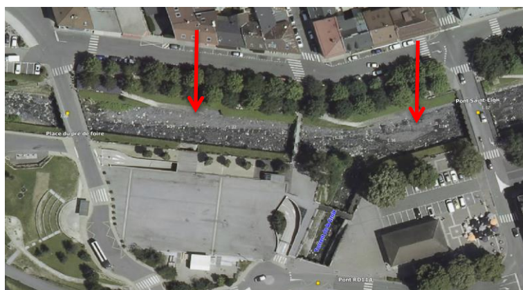
Figure 34 Banquettes de sédiments déposées par la crue de mai 2015
