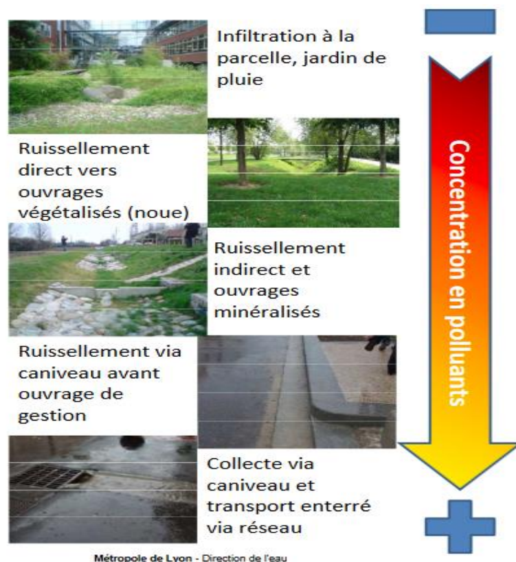
Figure 15 : Concentration en polluants des eaux de ruissellement en fonction des dispositifs de collecte utilisés
