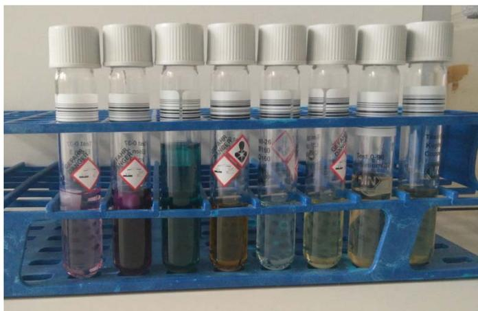
Figure 82 : Tubes de micro-méthode usagés de différents paramètres
