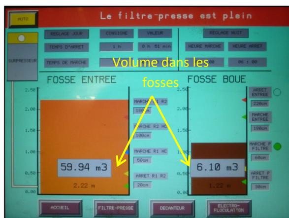
Figure 44 : Supervision : Niveau de remplissage des fosses (source : personnelle)
