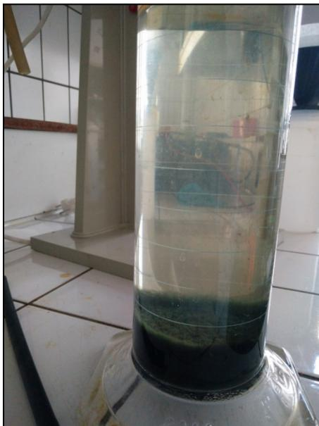
Figure 84: Floccs d'hydroxydes ferreux décantés (couleur verte)
