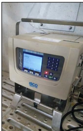
Figure 81 : Centrale d'acquisition de débits SATESE
