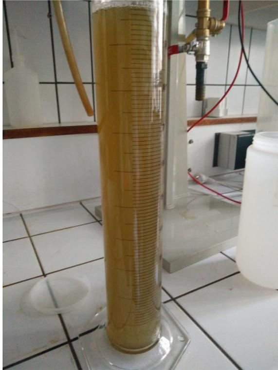
Figure 92 : Eau traitée avec une tension de 2V (pas ou peu de floes visibles)
