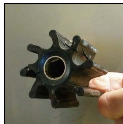
Figure 27 : Roue en caoutchouc des pompes FIP des modules d'électroflocculation (source : personnele)
