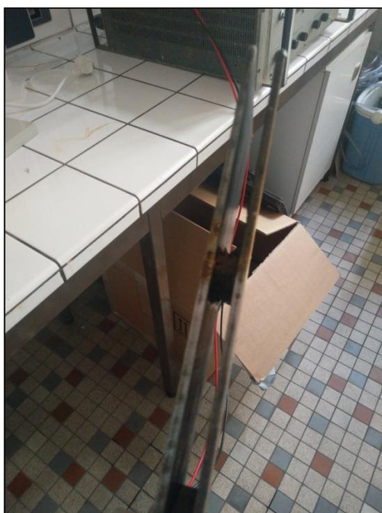
Figure 89 : Création de mousse entre les électrodes
