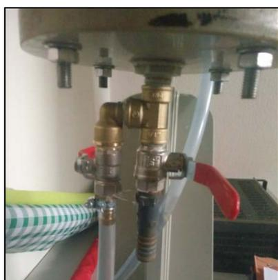
Figure 48 : Robinet de prise d'échantillon
