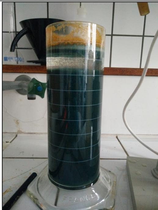
Figure 88 : Floccs flottants lors de la décantation
