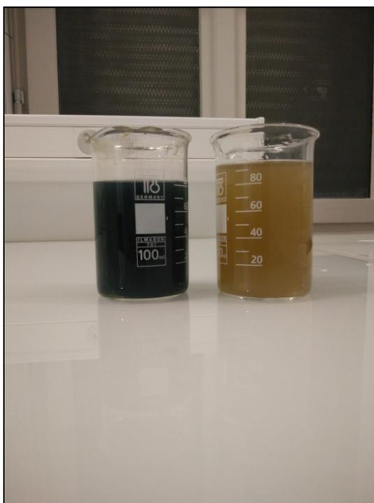
Figure 86 : Traitement avec les électrodes de fer (bêcher de gauche) ou d'aluminium (bêcher de droite) ; décanté et non décanté
