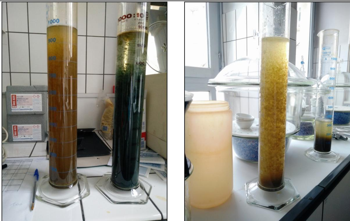
Figure 85 : Photo de gauche : temps de séjour = 4min à gauche ; temps de séjour = 15 min à droite ; photo de droite : pH = 3,5
