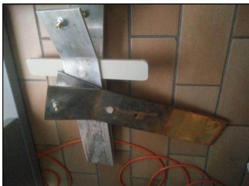
Figure 45 : Electrodes en fer ou en aluminium
