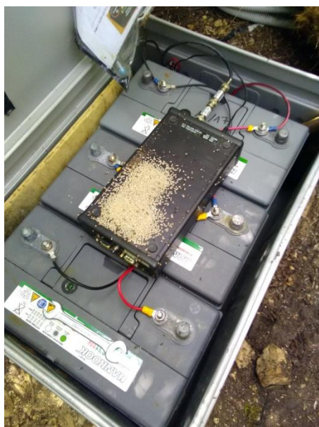
Figure 18: Photo de la station fixe (batteries et récepteur) (Source: GONZALEZ Guillaume)
