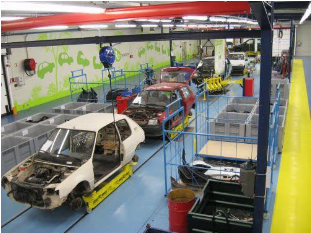
FIGURE 28 : CHAÎNE DE DÉMONTAGE DU CENTRE VHU DE PRUNIERS-EN-SOLOGNE (SOURCE : L'ARGUS PRO)
