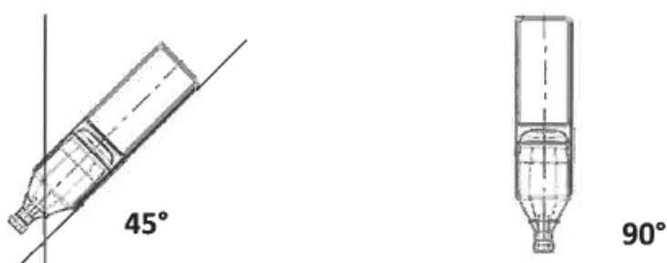
Figure 31 : Angle d'application du collyre pour la mesure de taille des gouttes.
