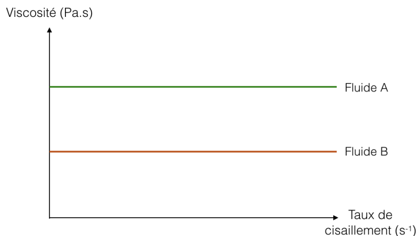
Figure 15 : Comportement d'un fluide newtonien.
