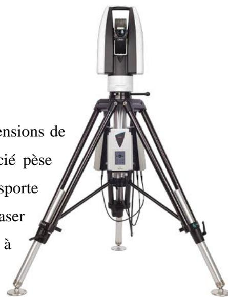
Figure 1 : AT9600 sur le trépied avec le contrôleur et les batteries ; Source :[4]
