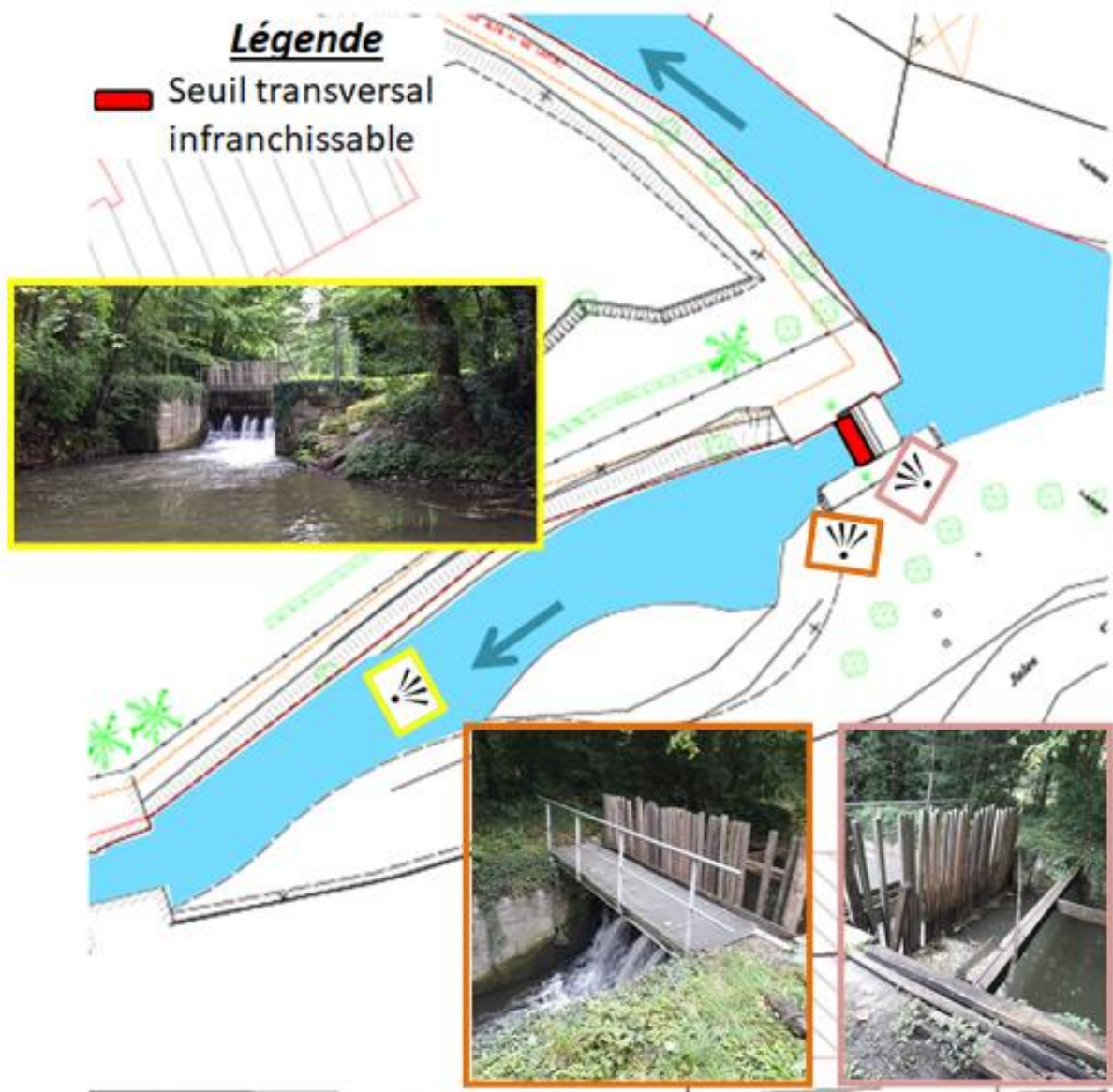
FIGURE 7 : LOCALISATION ET PHOTOGRAPHIE DU BARRAGE SAINT HUBERT (OH4)
