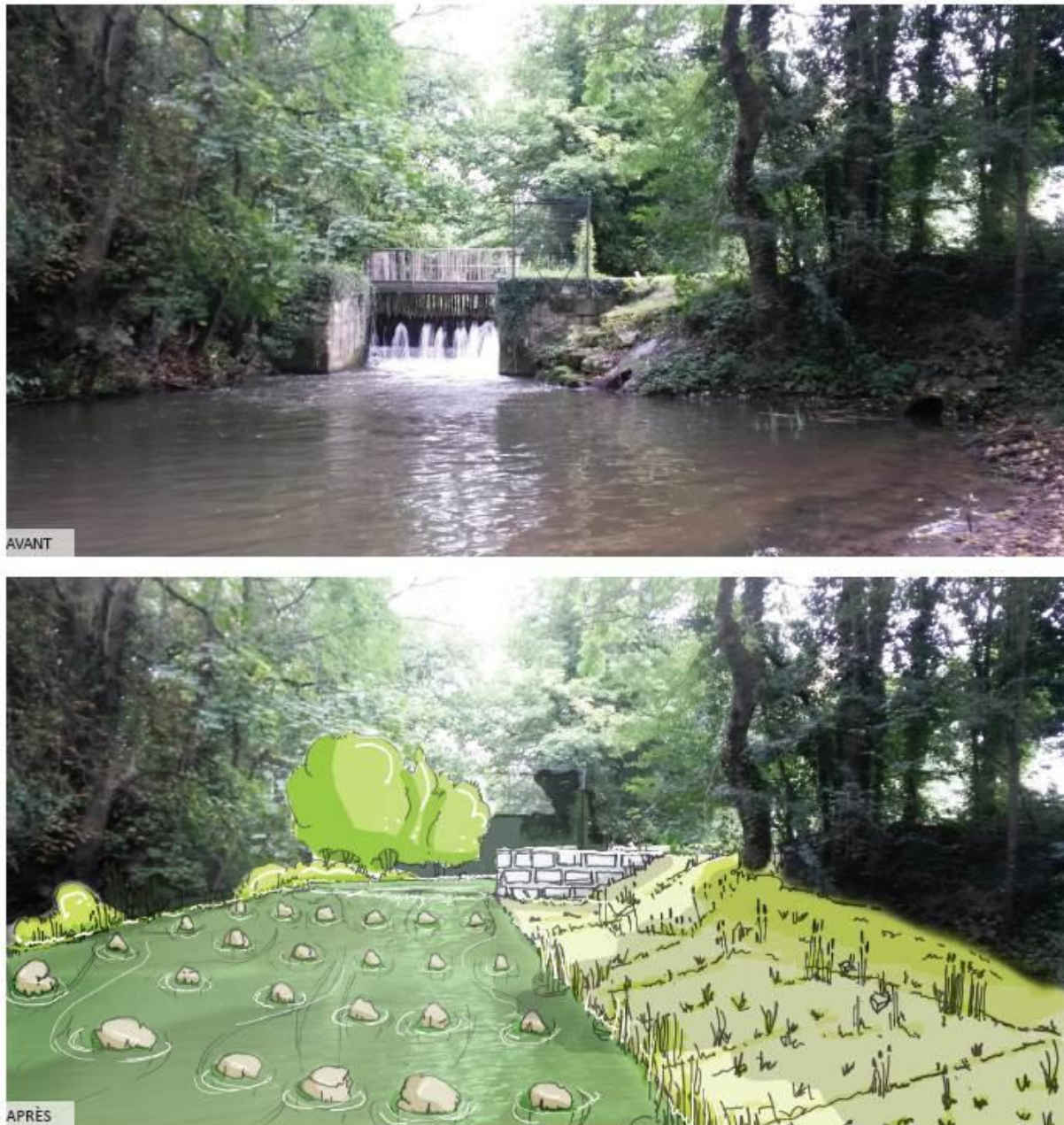
FIGURE 30 : PHOTOMONTAGE PAYSAGER DE LA RAMPE EN ENROCHEMENTS EN RANGEES PERIODIQUES (SOURCE : AEI)
