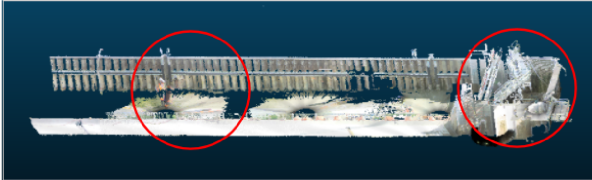
Figure 35: Nuage de points de l'écluse et zones traitées, Source : CloudCompare
