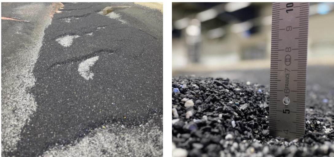
Figure 15: Mesures directes des longueurs et des hauteurs de dunes sur le modèle (essai 52, milieu)
