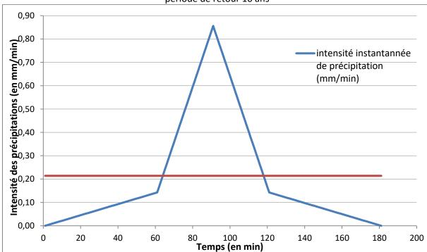
Figure 9 Intensité des précipitations en fonction du temps pour une pluie de 3h et une période de retour 10 ans
