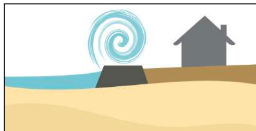
Figure 37 : Schéma d'un franchissement par paquets de mer (source : CEPRI 2016)
