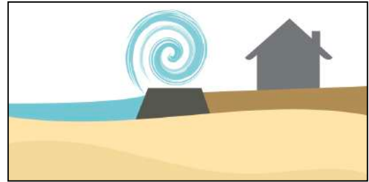
Figure 37 : Schéma d'un franchissement par paquets de mer (source : CEPRI 2016)
