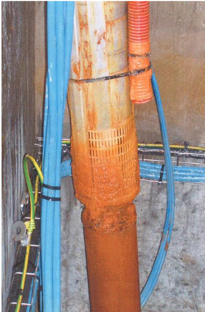
Moteur recouvert de dépôts et crépine colmatée
