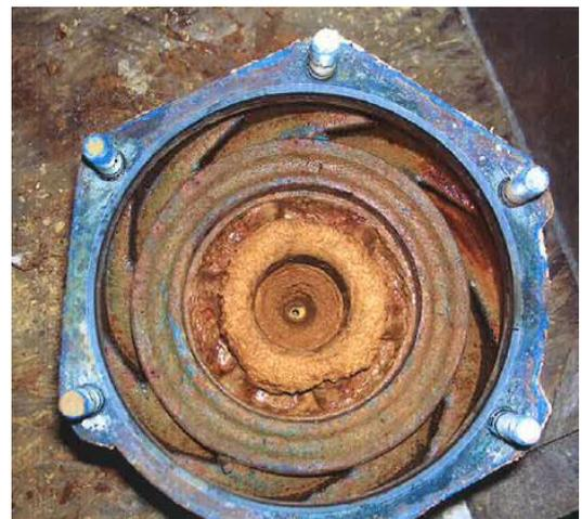
Dépôt au niveau du logement des coussinets
