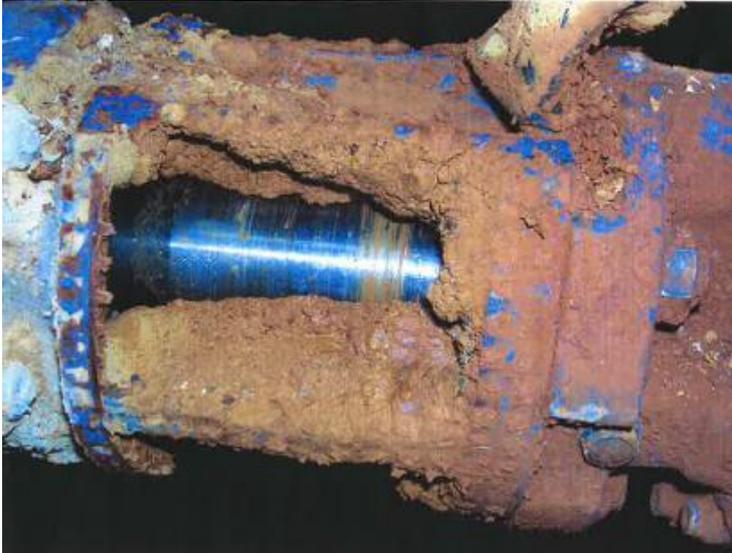
Dépôt sur les ailettes du corps d'aspiration après dépose de la crépine
