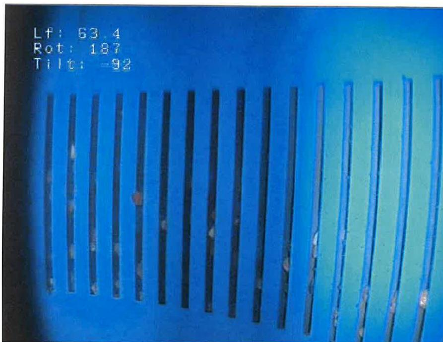
*Figure 9 : Massif filtrant engagé dans les crépines du forage (Rapport d'inspection télévisée du forage 205b, Gewatec, 2014)*
