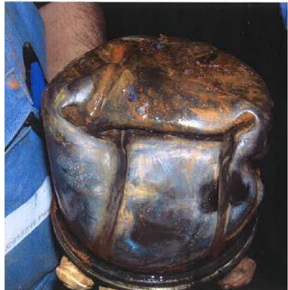
Membrane de dilatation anormalement déformée et rétractée
