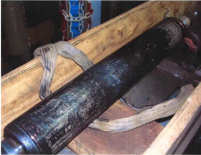
Dépôt noirâtre (carbone / graphite) sur le rotor. Dépôt provenant potentiellement du revêtement carbone du plateau de butée.
