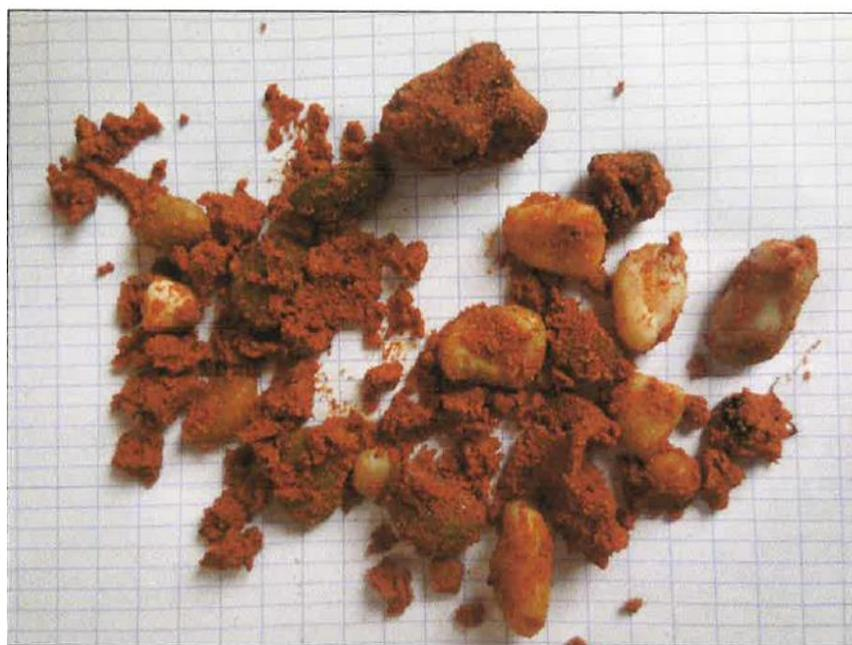
*Figure 10 : Massif filtrant évacué par air-lift du forage 234 (Gewatec, 2014)*
