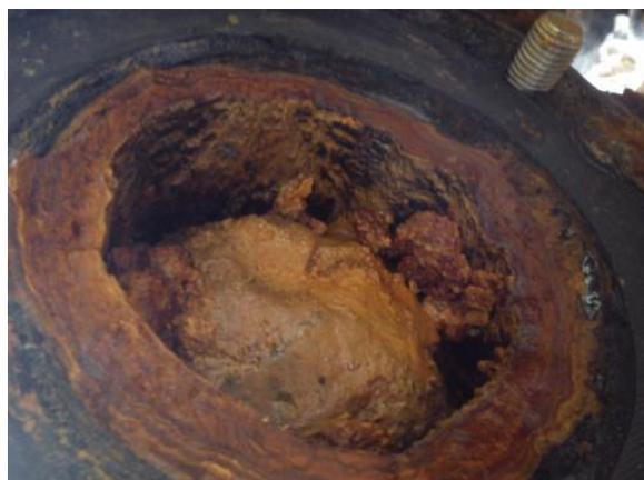
Encrassement du clapet de retenue par une boue orange
