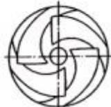
*Roue hélico-centrifuge fermée à écoulement semi-axial*
