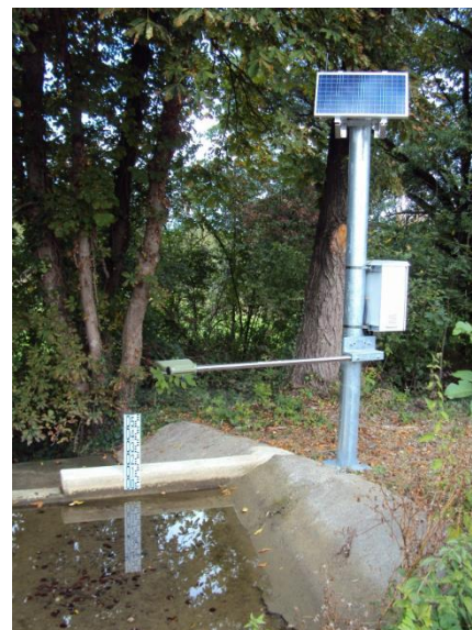
Figure 25 : Corde de vitesses, rigole de la Largue(droite) ; et Point de mesure de hauteur (radar) couplé avec une échelle limnimétrique, déversoir bief 29N
