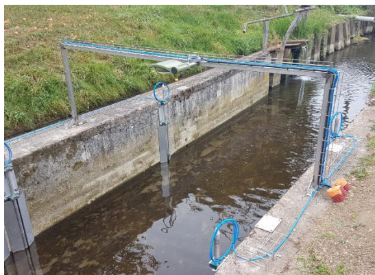
Figure 25 : Corde de vitesses, rigole de la Largue(droite) ; et Point de mesure de hauteur (radar) couplé avec une échelle limnimétrique, déversoir bief 29N
