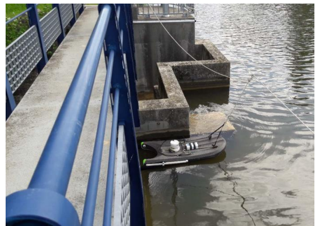
Figure 27 : Jaugeage avec ADCP, barrage 1 de Zillisheim 25/04/2019
