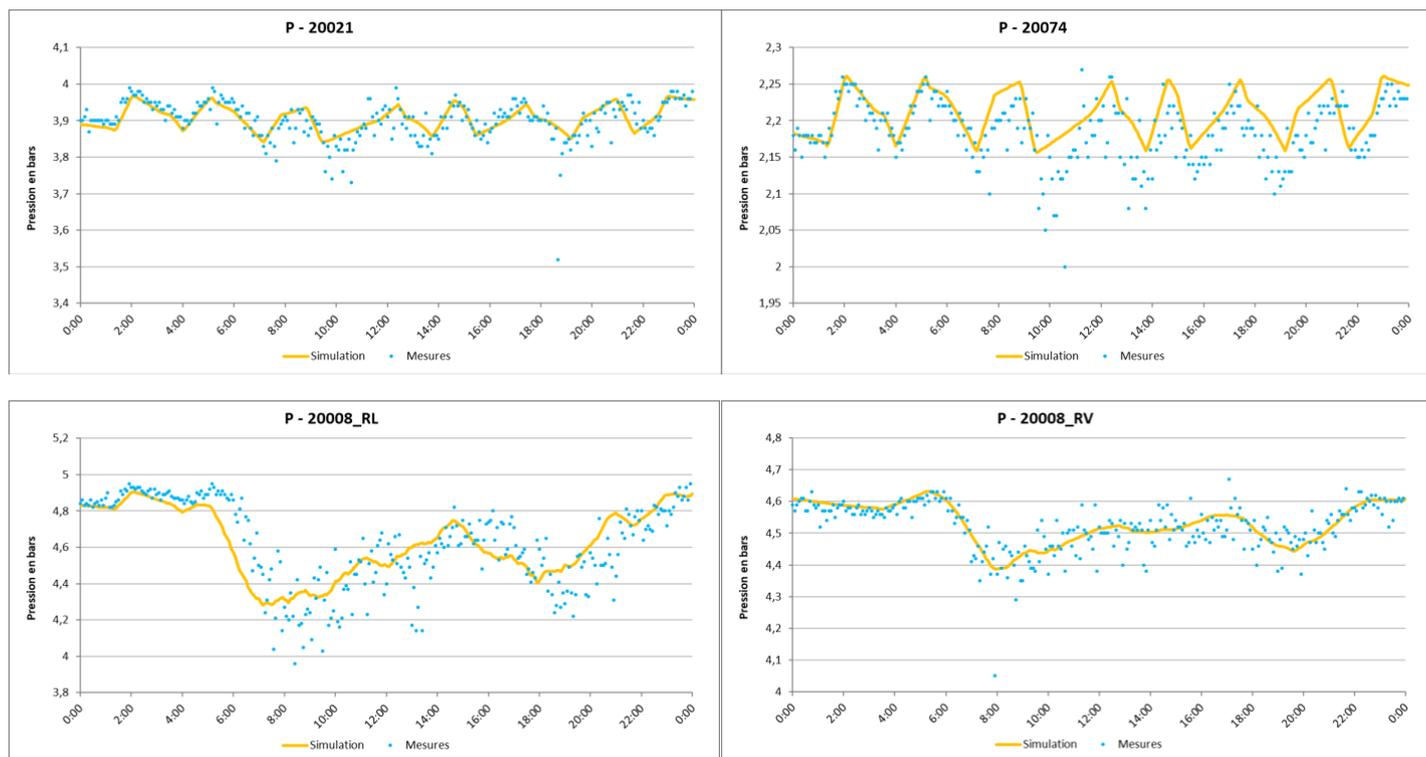
**Fig. 43. Courbes de calage des mesures de pression**
