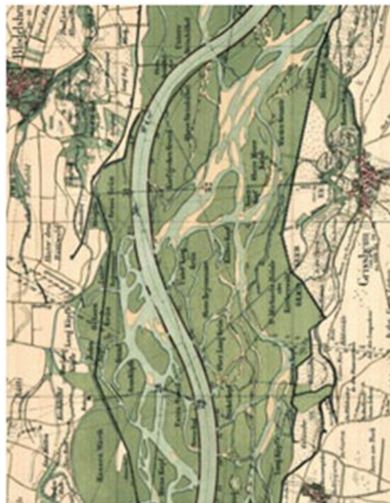
Le Rhin rectifié et régularisé. Le lit principal représente l'actuel Vieux-Rhin. Carte Lauf des Rheins, 1872.
