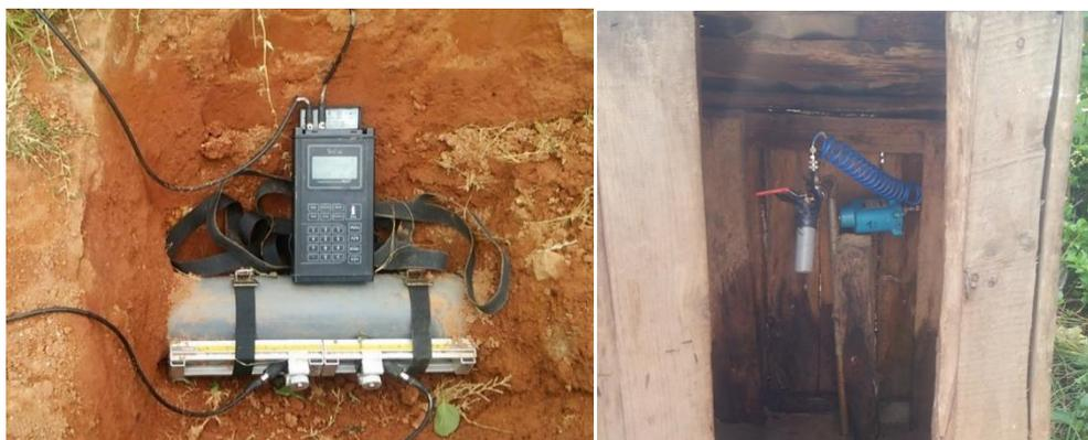
Pour les mesures de pression, des manomètres auto-enregistreurs ont été utilisés. Les 2 modèles de manomètres utilisés pour la campagne sont le LoLog R de HWM (Figure 19) et le PrimeLog de Primayer. Le positionnement des manomètres a été conditionné par la présence d'usagers de confiance chez qui l'installation pouvait se faire. Ces appareils ont été installés sur les points haut et bas du réseau, dans la mesure du possible.
