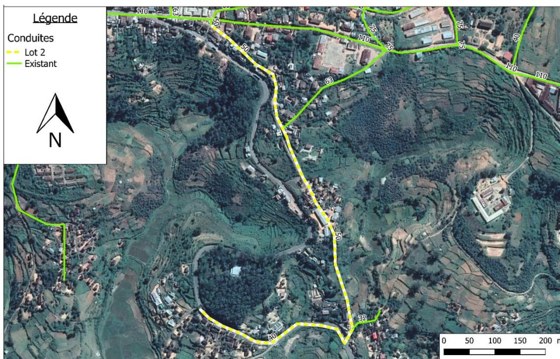
Un autre tronçon de DN63 est à remplacer à l'Ouest du réseau. Des fuites ont été repérées dans cette zone, ce qui empêche en partie le remplissage du réservoir d'Ambatolampy. Ce tronçon est présenté Carte 7. Le linéaire est de 255 m.
