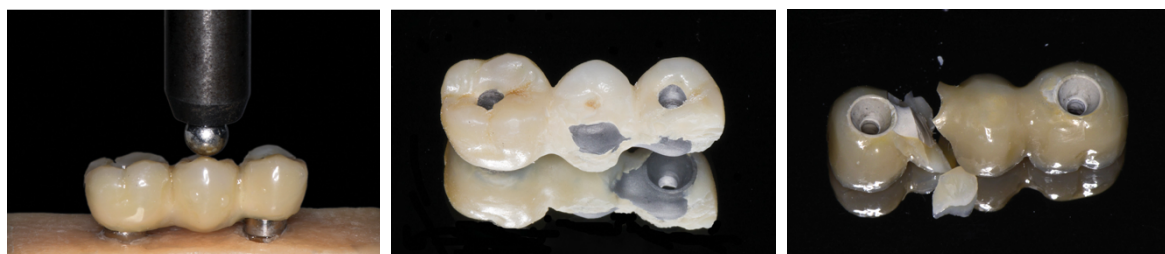
Figure 16 : Test de résistance à la fracture pour une prothèse (A) en armature titane (B) en armature PEEK[68]
