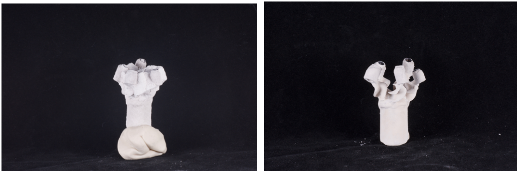
Figure 51 : piliers prothétiques en PEEK à la sortie du four (Courtoisie Mr Michael Santos)
