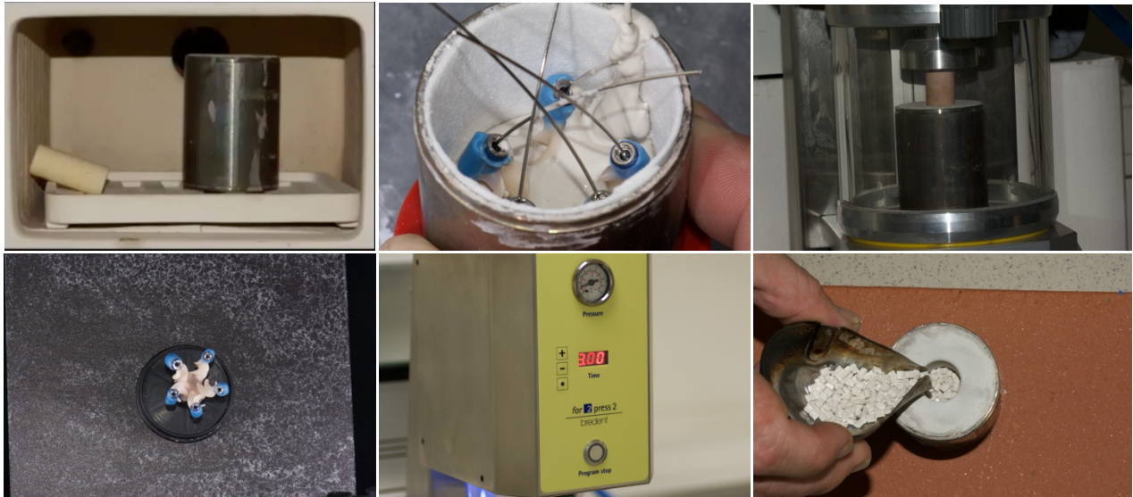
Figure 50 : Chauffe et pressage du PEEK dans le cylindre (Courtoisie Mr Michael Santos)
