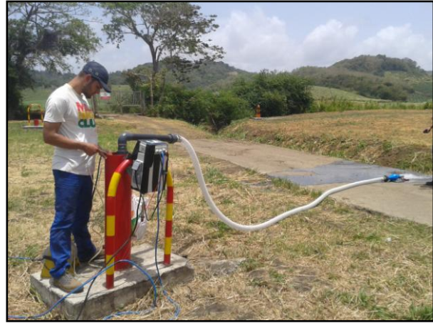
Mesure manuelle de la piézométrie
