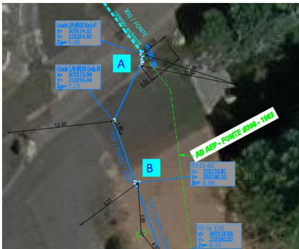
Figure 1: Extrait d'un ancien plan de récolement à l'échelle 1/200 dans le système planimétrique Lambert II et le système altimétrique IGN69. On retrouve en fond de plan une carte aérienne mais la taille pixel sol étant de 20 centimètres, il est impossible de prendre des mesures à partir de celui-ci (source : plan Kadran).
