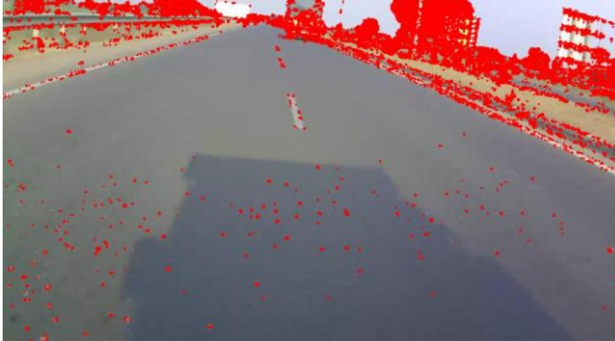
Figure 2: Représentation des points d'intérêt sur un sol relativement lisse, on s'aperçoit que si l'on ne filme pas les bâtiments aux alentours, leur nombre diminue drastiquement et la qualité du suivi de mouvement sera dégradée. (source : illustration provenant du forum dsp.stackexchange.com consulté le 02/06/2021).
