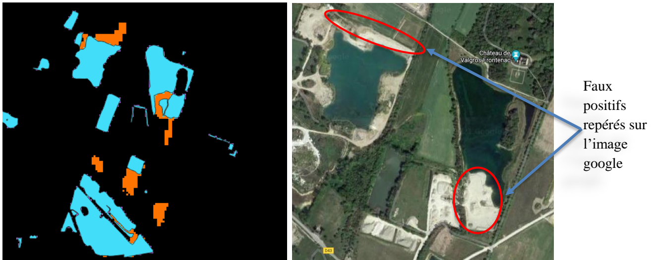
Figure 22 : Mise en évidence des faux positifs par rapport à la base de données sandre
