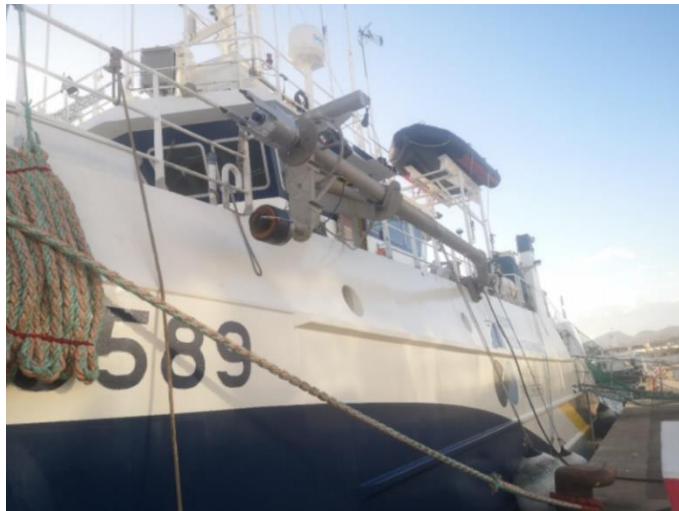
Figure 7: Le navire L'Europe avec la perche acoustique en gris - Photo réalisée par mes soins.
