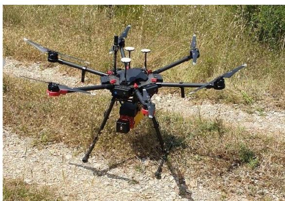
Figure 18: Drone M600 PRO avec un Lidar Vx-20
