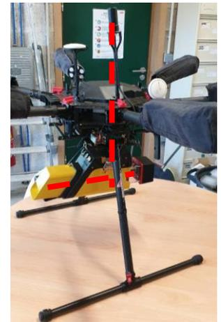
Figure 21: Bras de levier du Lidar
