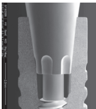
Figure 71 : Vue au microscope d'une coupe verticale de l'implant Ankylos (Dentsply Implants) avec un pilier dont le diamètre est réduit par rapport à celui de l'implant. (93)
