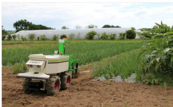
Figure 2 : Désherbage inter-rangs au robot
