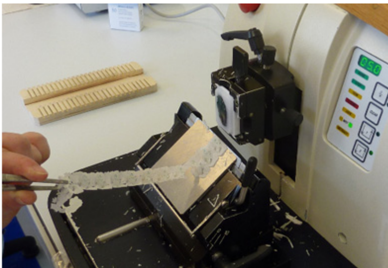
Figure 12 : Technique de préservation du bloc par ruban.
