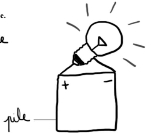
L'ampoule brille si une lame de la pile touche le plot et l'autre lame touche le culot.
