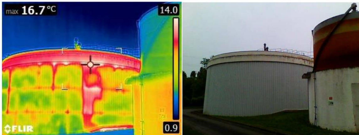
Figure 38 : Extrait des résultats de la thermographie du digesteur
