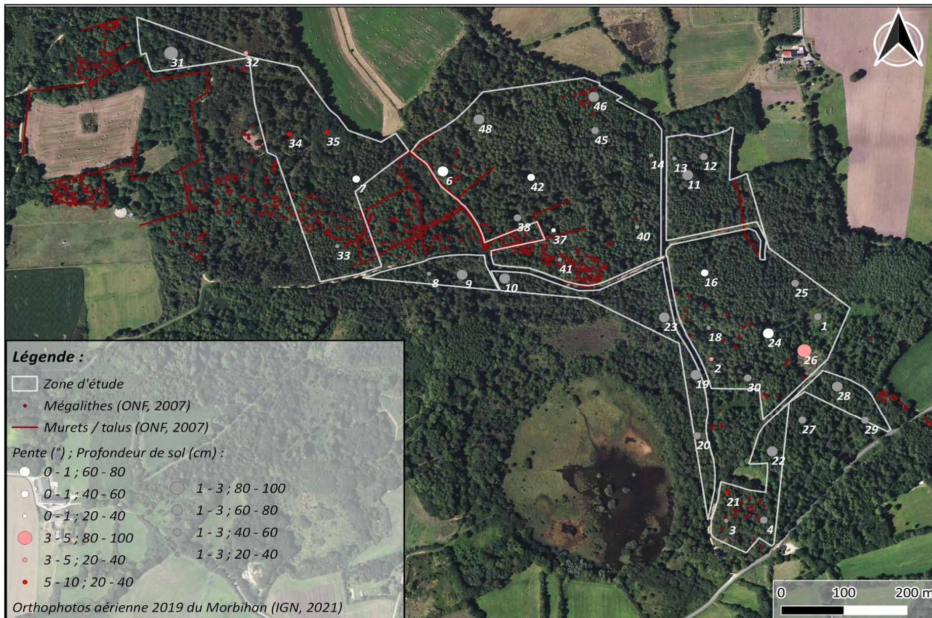
Figure 32 : carte des pentes et des profondeurs des sols, au droit des points échantillonnés
