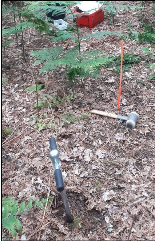
Figure 6 : mise en œuvre d'une gouge graduée pour les prélèvements de sol
