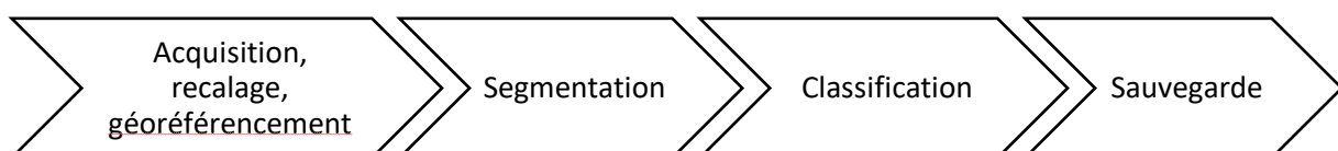
Figure 18 Les grandes étapes du traitement du nuage de points de corps de rue
