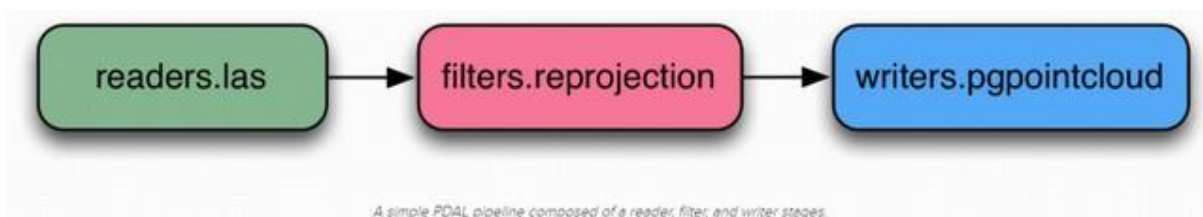
Figure 5 Le fonctionnement en pipeline de PDAL
