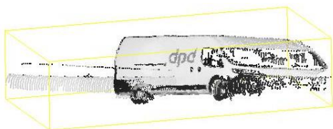
Figure 41 Un camion et une voiture scannés au même endroit depuis deux stations différentes
