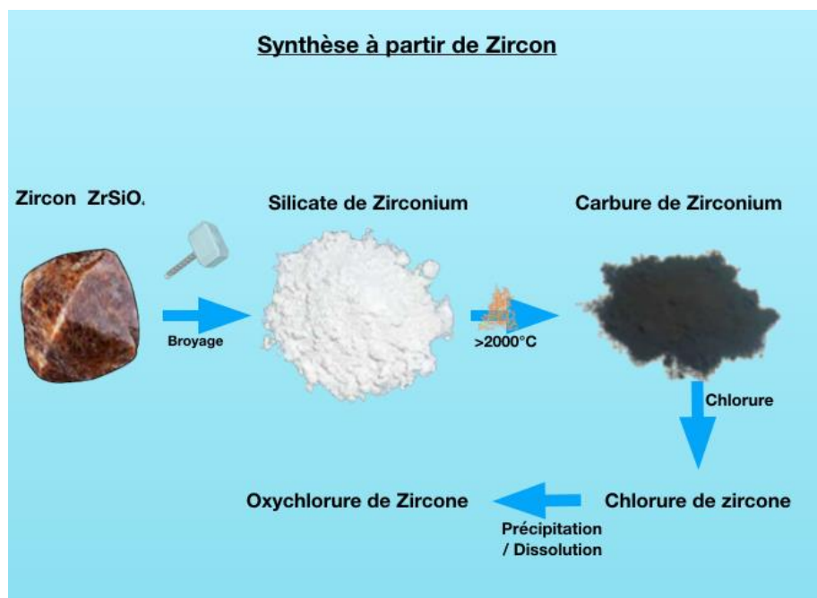
Figure 8 : Synthèse de l'oxychlorure de zircon.
