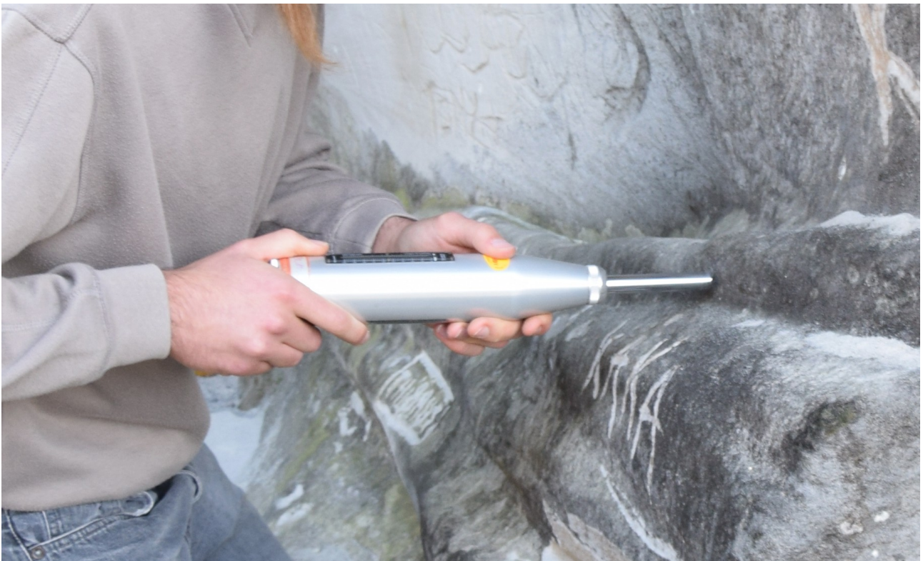
Mesure de dureté du grès à Darvault (77) avec un scléromètre
