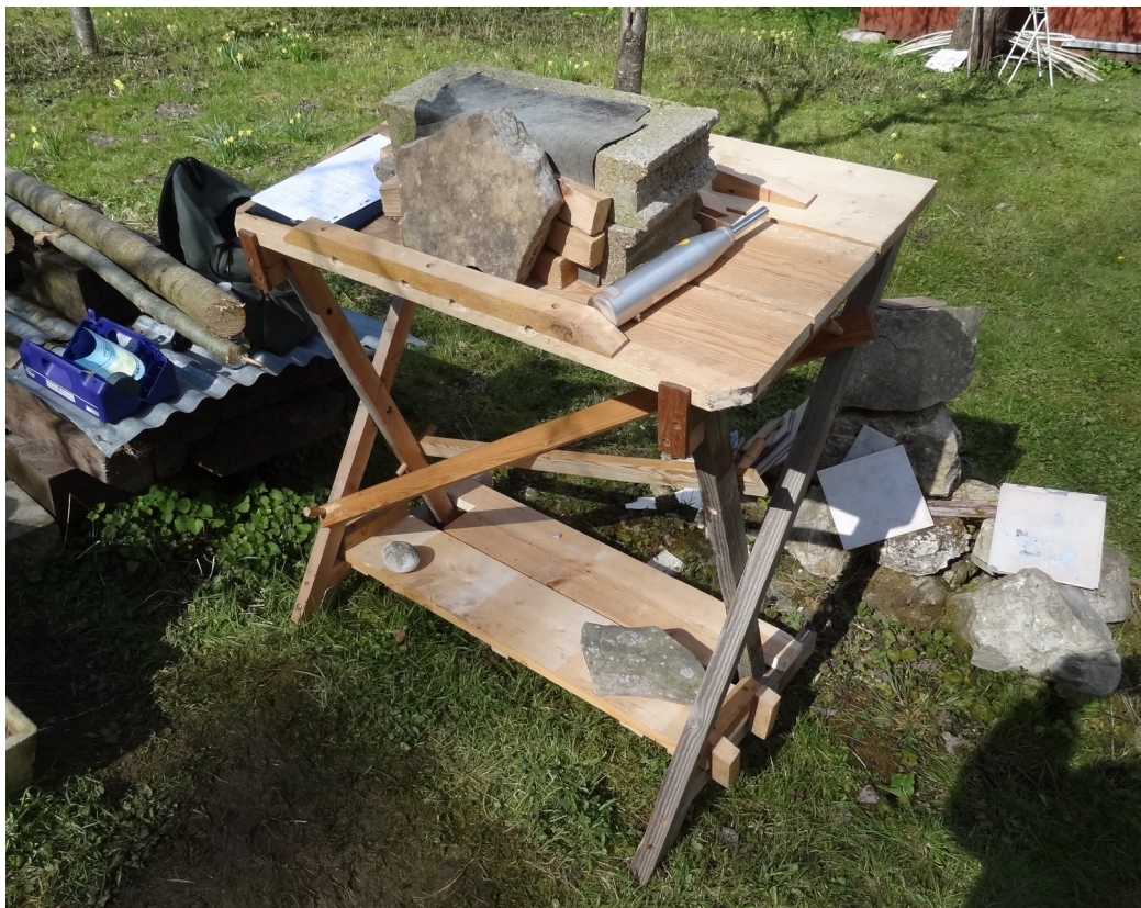
Fig 20 : Installation des blocs pour leur percussion avec le scléromètre.
