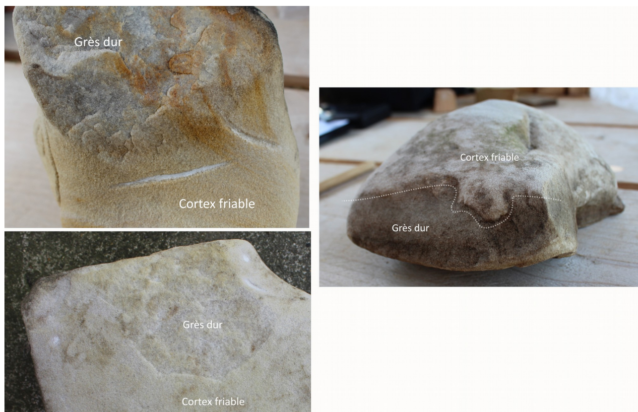
Fig 22 : Interfaces cortex friable/grès dur sur blocs expérimentaux.
