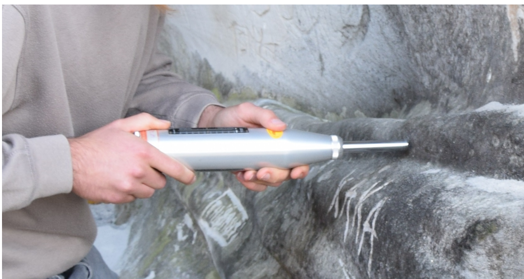
Fig 19 : Scléromètre en cours d'armement pour une mesure de dureté au choc sur une paroi de grès gravable de carrière (photo : Médard Thiry).
