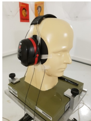
Figure 11: Tête ISL utilisée pour les essais selon la méthode du mannequin
