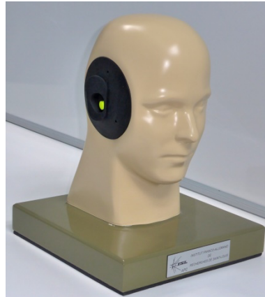
Figure 4: La tête ISL utilisée pour les mesures avec la méthode du mannequin
