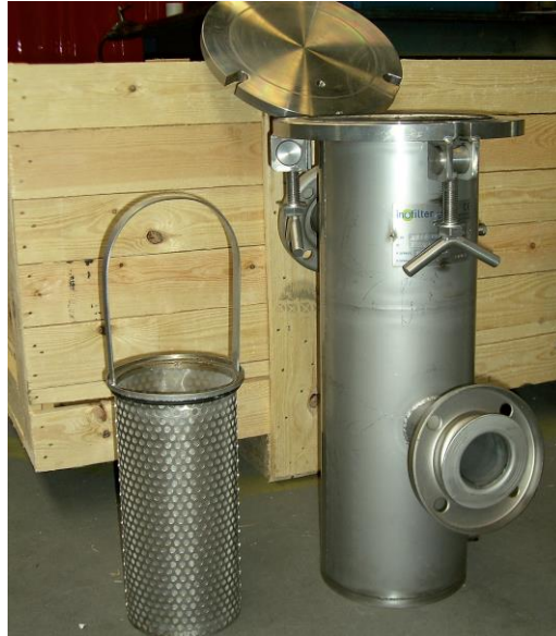
Figure 34 - Nouveau filtre à tamis
