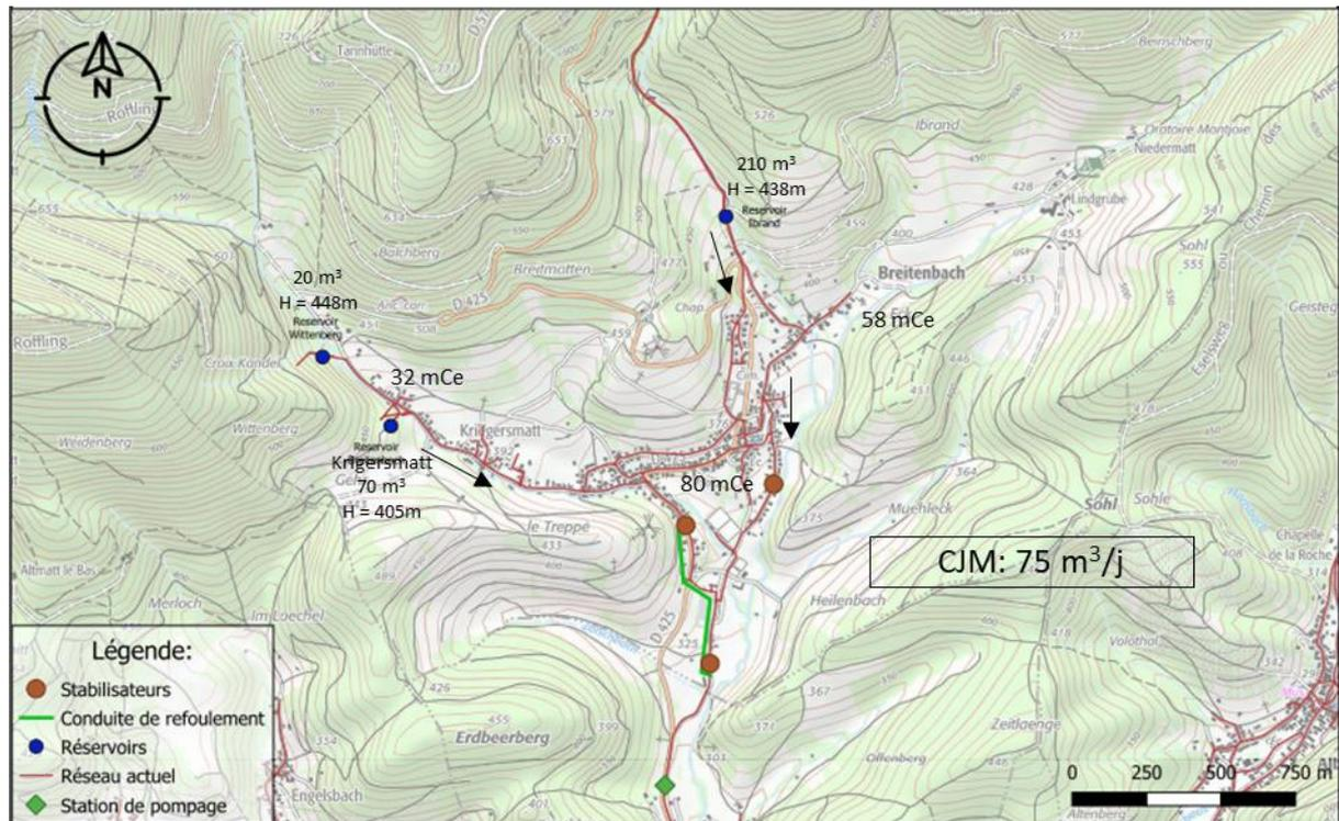
Figure 27: Mise en place d'une station de pompage à Breintebach et quelques pressions statiques associées
