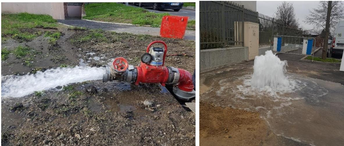
Figure 48 : Pesage du PEI avec un pèse-bouche (à gauche), essai de hauteur (à droite)
