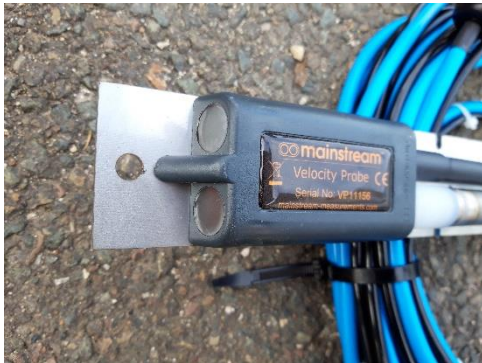
Figure 12 Sonde piézorésistive pour la mesure de hauteur et capteur de vitesse (doppler), source Chartres métropole
