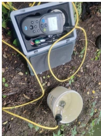
Figure 19 : Mesures du potentiel redox avec le multi-paramètres (photo du 30/06/2021)
