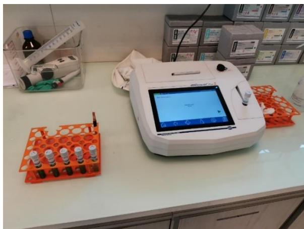
Figure 46 : Analyses de \text{NH}_4 le 14/09/2021 à l'aide d'un spectrophotomètre
