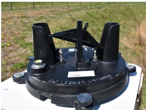
En complément des mesures de la station privée de Sciez, nous avons mis en place un pluviomètre à auget basculant à proximité des BV "Parking" et BV "Rural", sur la commune de Thonon-les-Bains (cf. plan de situation en annexe n° 7). Cela permet de disposer de mesures plus locales et à un pas temps plus faible.
