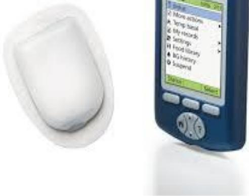
La pompe OMNIPOD, elle, est une pompe dite « patch » car elle est directement apposée sur la peau. Le cathéter sous-cutané est donc directement relié au réservoir d'insuline et fait partie des constituants du POD placé sur la peau. Celui-ci contient un réservoir de 200 unités d'insuline maximum, une canule souple, un introducteur, une pompe et des piles. La pompe dispose d'un deuxième élément pour fonctionner, le PDM (Personal diabetes manager) qui est une télécommande utilisée pour piloter le
