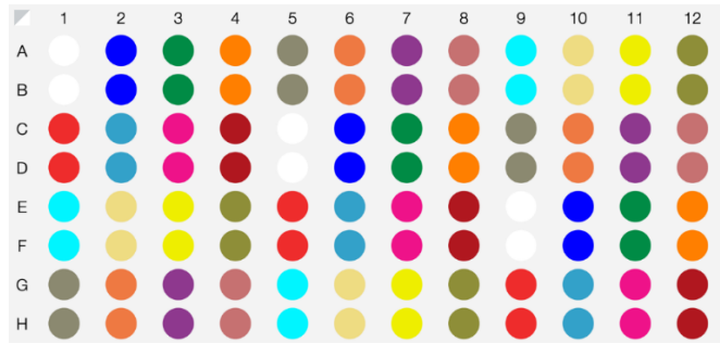
Figure 27 : plan de plaque, des 15 échantillons et du contrôle négatif H 2 O, rentré sur le logiciel QuantStudio™ Design & Analysis 2.5.0
