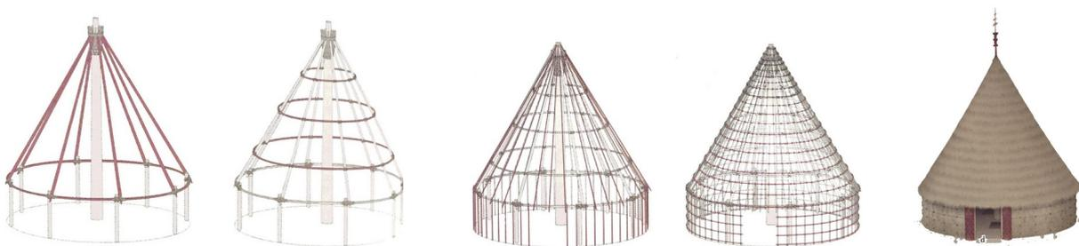
*Figure 7 : Étapes de construction d'une case traditionnelle kanak*
