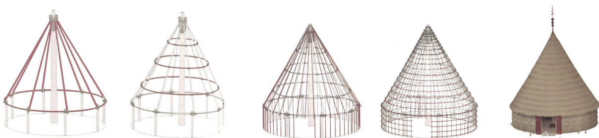
Figure 7 : Étapes de construction d'une case traditionnelle kanak
